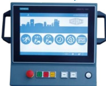
Industrie-PC mit 12" Touch-Panel integrierter RFID-Reader
