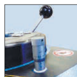
Микрометр позволяет легко задавать диаметр обжима.
