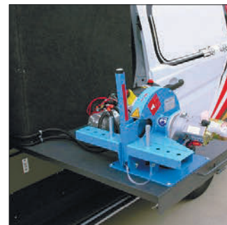
Устройство для намотки рукавов UWT 2 + прибор для измерения длины рукавов UMS 4
