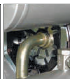
Прессы серии S 6 можно использовать для обжима коротких отводов 90° с длинными наконечниками. При использовании стандартных обжимных машин это было бы невозможно.
