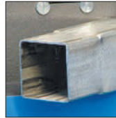
Специальные кулачки для формования труб с квадратными или круглыми концами.
