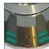
Обжимные прессы серии S 8 / 10 используют систему пластин скольжения, гарантирующую высокий уровень чистоты.
