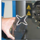
Специальные кулачки для формования труб с квадратными или круглыми концами.
