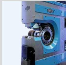
Vorstellung der HMC 12-2000, stärkste 8-Backen C-Pressen mit 2000 Tonnen Presskraft und UNIFLEX Gleitlagertechnologie.
