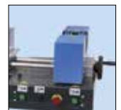
Axial verstellbare Spanneinheit verhindert das Knicken kleiner Schlauchennweiten.
