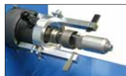
Gleichzeitiges Innen- und Außenschälen möglich (USM 100)
