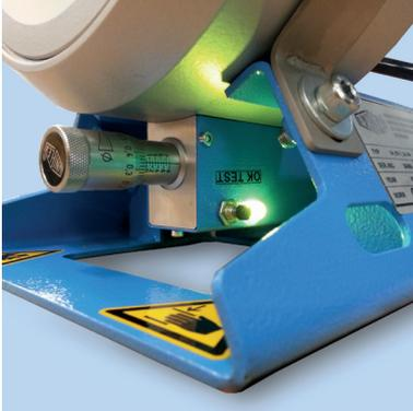
Bei den S2 M Modellen gibt es ein optisches Signal wenn das Pressmass erreicht ist. Die elektrischen Varianten haben eine Stoppautomatik.
