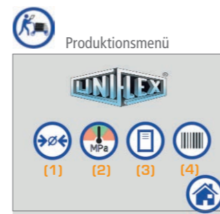
Mehr Parameter um komfortabel Serien zu verpressen. Auswahlmü für Pressen per Pressmaß oder Druck durch Produktionsdaten aus der Datenbank oder per Auslesen mit dem Barcode Scanner.
