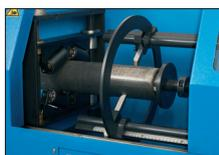
Doppelarm-Schneidewerkzeug mit Schlauch.
