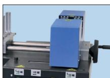
Axial verstellbare Spanneinheit verhindert das Knicken kleiner Schlauch­nennweiten.
