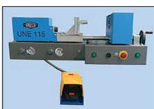
Geschützte Bedienelemente und frei positionierbares Fußpedal.
