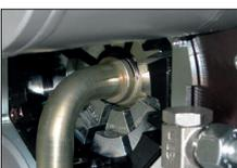
Die SC 6-Serie verpresst selbst kurze 90°-Armaturen mit langem Bogen. Dies ist mit keiner anderen konventionellen Maschine möglich.
