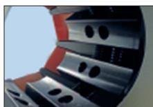
Mit Hilfe der zwei Positionsbohrungen in den Grundbacken lassen sich Verpressungen an Vorder- und Rückseite durchführen.
