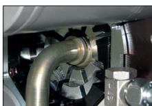
Die SC 3- und SC 4-Serien verpressen selbst kurze 90°-Armaturen mit langem Bogen. Dies ist mit keiner anderen konventionellen Service-Maschine möglich.
