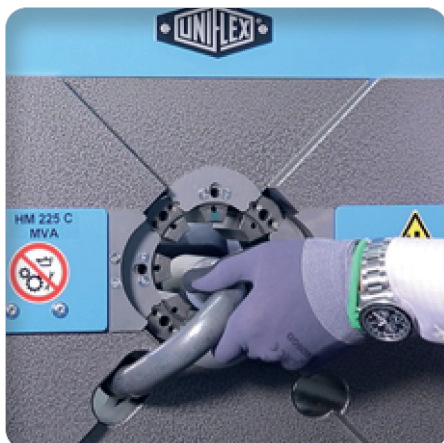
Sondermaschine HM 225 (IPC) mit Aussparung für 180° Armaturen
