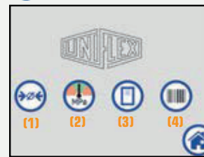
Mehr Parameter, um komfortabel Serien zu verpressen. Auswahlmenü für Pressen per Pressmaß oder Druck durch Produktionsdaten aus der Datenbank oder per Auslesen mit dem Barcode-Scanner
