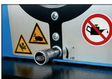
Das Mikrometer ermöglicht die einfache Einstellung des Pressdurchmessers.
