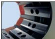
Mit dem Zwei-Loch-System wird das Einsetzen der Pressbacken von beiden Seiten vereinfacht und die Möglichkeit geboten, pro Seite zwei unterschiedliche Positionierungen zu wählen, passend zum jeweiligen Pressbackentyp. Die HM 3 H ist kompakt und bietet eine gute Zugänglichkeit.
