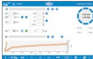
Eingabe von Pressmaß, Korrekturwerten, Haltezeit, Öffnungsdurchmesser, Vorwahlzähler und Pressbacken (automatisch).
