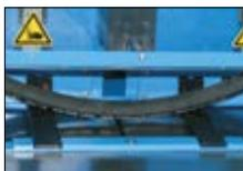
Biegebolzen für gerade Schnitte und zur Entlastung des Trennmessers.
