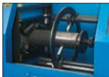
Doppelarm-Schneidewerkzeug mit Schlauch.
