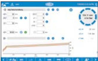
Die PFM-Funktion ermöglicht die permanente Überwachung des Pressdruckes bzw. des Pressdurchmessers während der Fertigung. Verlässt ein Parameter den angerlegten Soll-Bereich wird die Verpressung sofort gestoppt und dem Bediener eine Meldung angezeigt. Damit können fehlerhafte Bauteile bereits während der Produktion mit großer Sicherheit erkannt werden.
