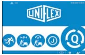
Der Queue-Modus führt in einer Datenbank hinterlegte einzelne Pressdatensätze in der Fertigung nacheinander aus. Somit können für einzelne Werkstücke spezifische Parameter vorgeben und rückgemeldet werden (z.B. One-Piece-Flow).
