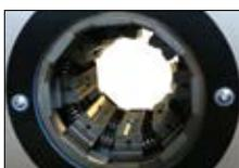
Der große Öffnungsweg ermöglicht das Durchführen von 90°-Armaturtypen ohne das Wechseln der Pressbacken.
