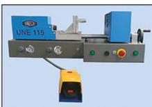
Geschützte Bedienelemente und frei positionierbares Fußpedal.
