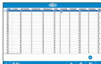
In der Logdatei-Übersicht werden gespeicherte Pressparameter angezeigt.
